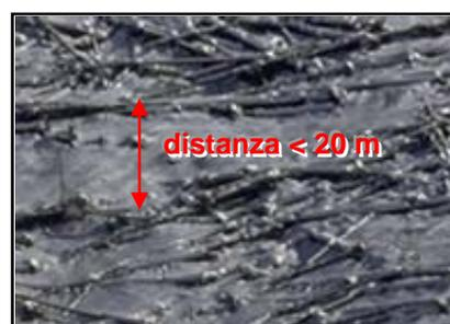
Figura 5: Distanza massima tra elementi che, tenendo conto della loro altezza utile, potrebbero essere ritenuti come «opere di protezione» (zona non sgomberata a Disentis (GR) durante l'inverno 1998/99).
